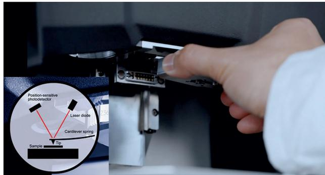
**Bild 1.** Einsetzen des Actuator Bodys inklusive Cantilever in das AFM: Der z-Sensor ist ohne jegliche Kabel in dem kompakten und leichten Actuator-Body verbaut
